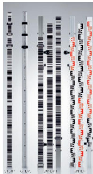
**GT4L, рейка телескопическая фибергласовая** Черырхексекционная телескопическая рейка. Двусторонняя - со штрих-кодом и мм отметкой. Имеется транспортный чехол. Длина от 1,2 м (3,94 фута) до 4,0 м (13,12 фута), вес 2,2 кг (4,9 фунта), коэффициент расширения 10 ppm/°C.
