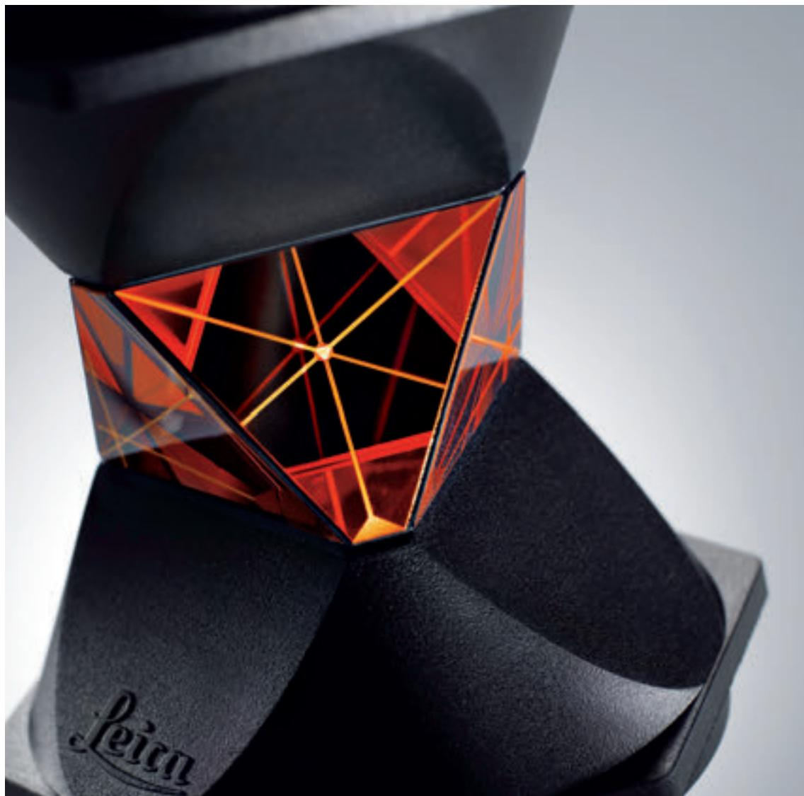
На дальность измерения до призмы влияют, среди прочего, покрытие и геометрия оптического стекла. Многие оригинальные призмы от компании Leica Geosystems имеют специальное покрытие на отражающих поверхностях – антибликовое, и медное покрытие на обратной стороне. Без этого диапазоны измерения расстояния, ATR и сложного поиска снизились бы до 30%.
